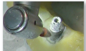
8) La surface de l'implant est lissée davantage avec le polisseur brun 9501M , un brillant mat est obtenu.
